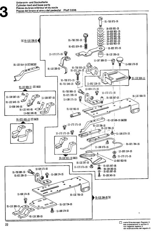
Unterarm- und Sockelteile Cylinder-bed and base parts Pièces du bras inférieur et du socle Piezas del brazo al aire y del pedestal Pfaff 3306
