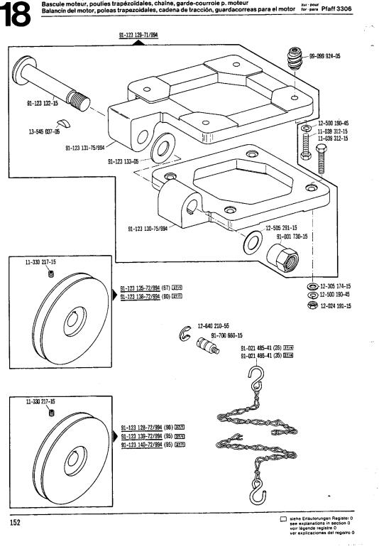
Motorwippe, Keilriemenscheiben, Zugkette, Riemenschutz zum Motor Motor bracket, v-belt pulley, chain, belt guard for motor Bascule moteur, poulies trapézoïdales, chaîne, garde-courroie p. moteur
