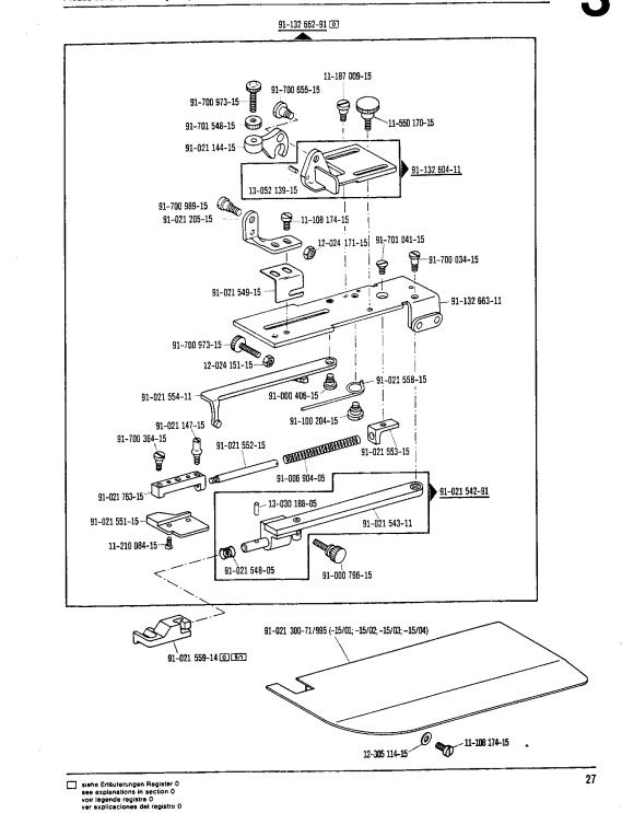
Unterarm- und Sockelteile Cylinder-bed and base parts Pièces du bras inférieur et du socle Piezas del brazo al aire y del pedestal Pfaff 3306
