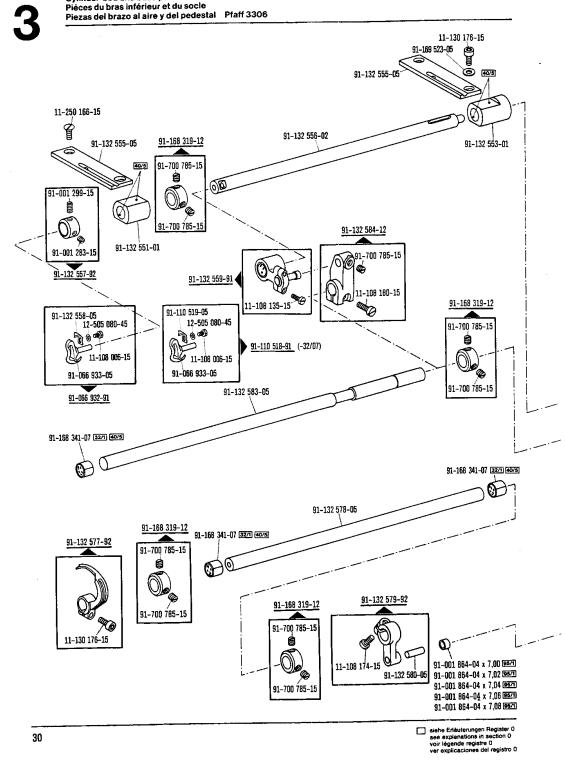
Unterarm- und Sockelteile Cylinder-bed and base parts Pièces du bras inférieur et du socle
